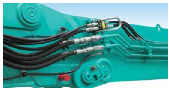
Leitungsanschluss: Multi-Kupplungssystem an der Auslegerseite.
