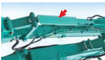
Protezione del cilindro della benna rinforzata con struttura scatolare
