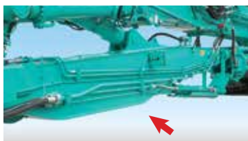
Cablaggi elettrici a disposizione ottimizzata con copertura totale per evitare danni
