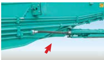
Disposizione dei flessibili idraulici ottimizzata per fornire la massima protezione dai danni
