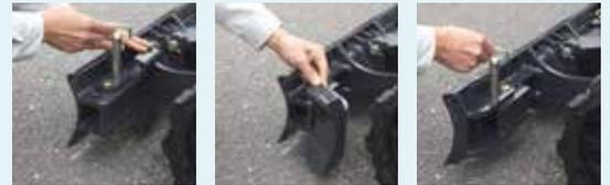
La lame de nivelage, équipée de charnières à goupille, peut être rapidement élargie ou rétractée.
