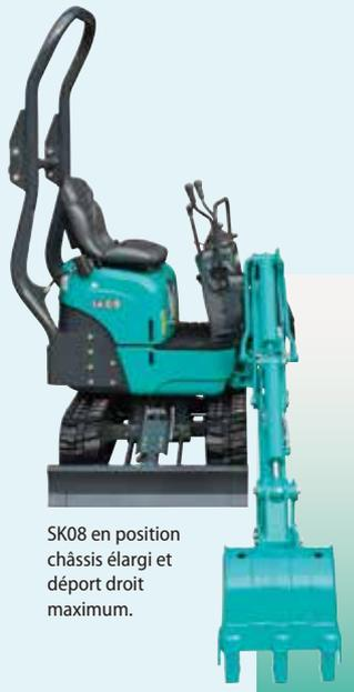
SK08 en position châssis élargi et déport droit maximum.
