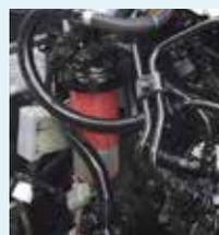
Filtere à carburant équipé d'un décanteur.
