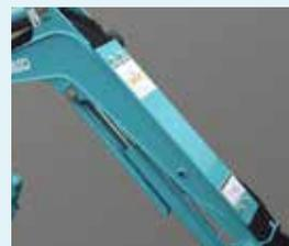
Capot de protection des flexibles au dos de la flèche.
