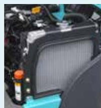
Radiateur en aluminium anticorrosion.
