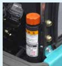
Huile hydraulique longue durée (1000 heures) et orifice de remplissage accessible.
