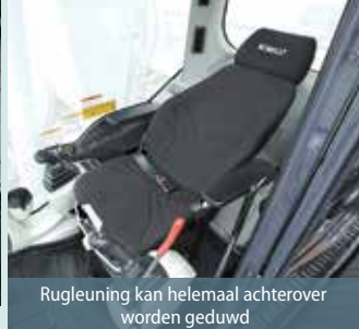
Door de dubbele geleiders kan de stoel geheel naar wens worden versteld
