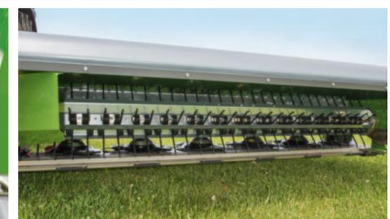
Die Rollenaufbereiter RC sorgen für eine schonende Aufbereitung ohne Blattverluste. Bei Abnutzung oder Beschädigung können die Gummielemente einzeln getauscht werden.
