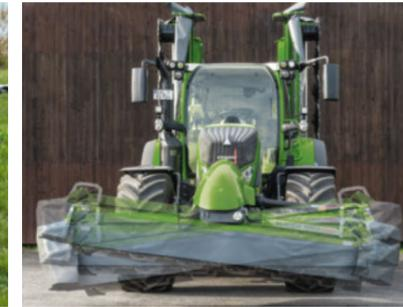
Die Fendt Slicer 310 FPK sind dank speziellem Pendelbock besonders nahe am Traktor und somit äußerst wendig.
