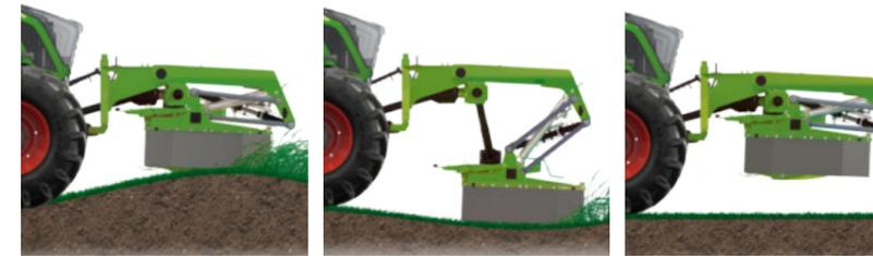
Am Vorgewende profitieren Sie von einer sehr hohen Bodenfreiheit und beschädigen keine Schwade.
