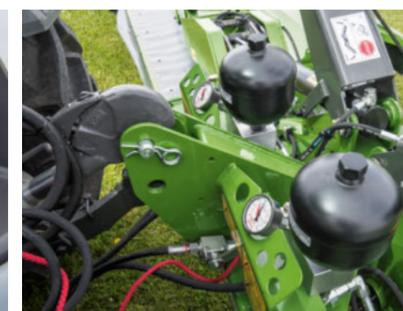
Behalten Sie mit dem Manometer stets den perfekten Auflagedruck des TurboLift-Systems im Blick und passen Sie ihn von der Kabine aus an.
