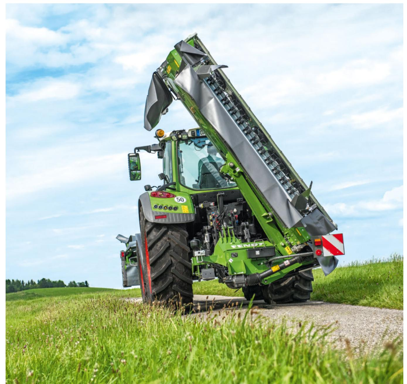
FENDT SLICER TL: HECKANBAU MIT MITTENAUFHÄNGUNG
