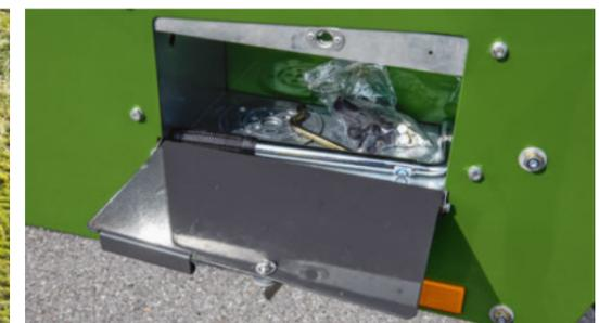
Für schnelle Wartungsarbeiten ist eine Werkzeugkiste in der Deichsel des Fendt Slicer 3575 T integriert.
