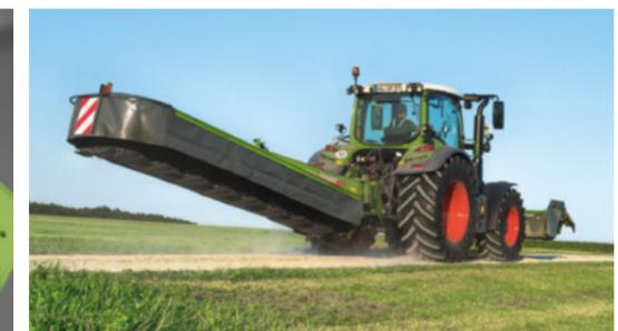
Die hydropneumatische Mähbalkenenlastung TurboLift ermöglicht den einmaligen, schwebenden Schnitt.
