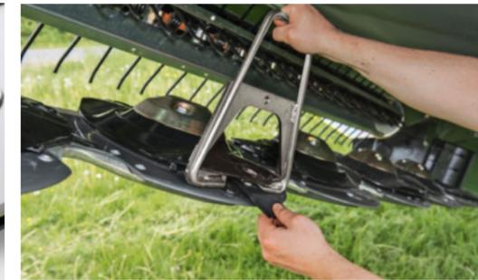
Mit den leicht austauschbaren DriveGuard-Scheiben ist der Kompaktwinkelantrieb perfekt geschützt.
