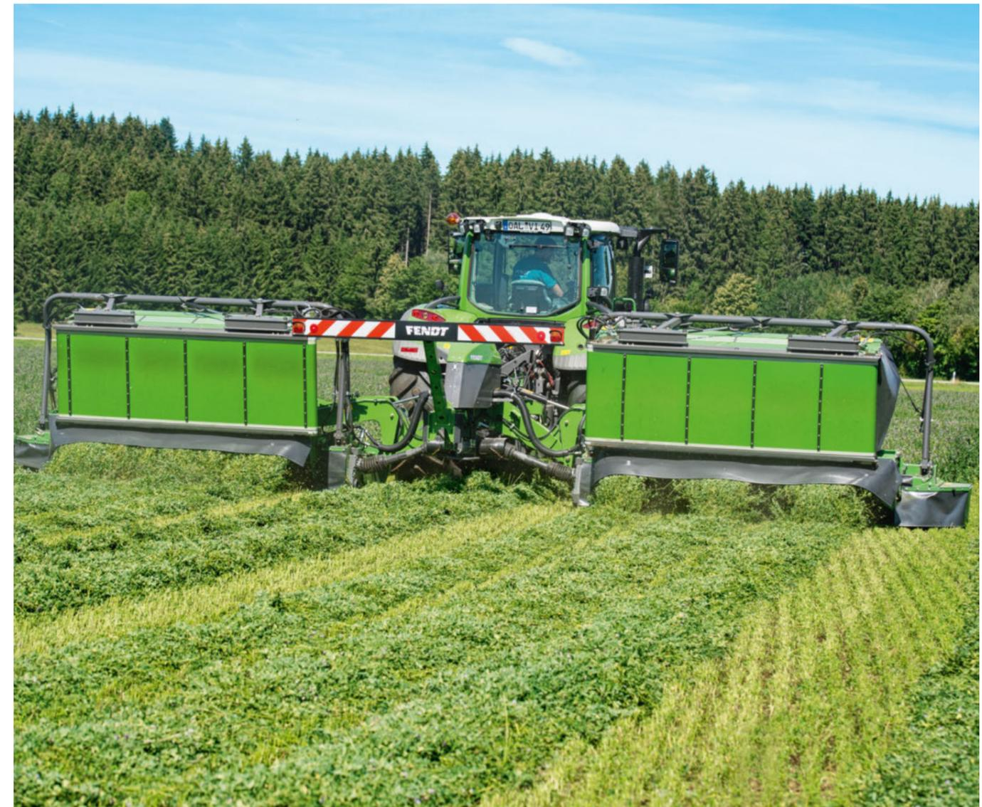
Per Tastendruck klappen Sie die Bänder nach oben und legen das Erntegut auf der gesamten Breite ab.
