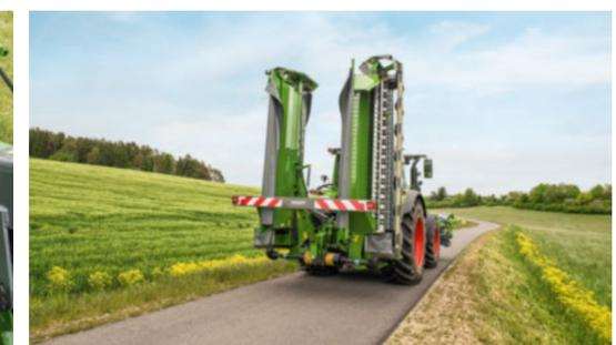
Im geklappten Zustand bleibt die Mähkombination unter 4 m Höhe und kann durch den niedrigen Schwerpunkt komfortabel gefahren werden.
