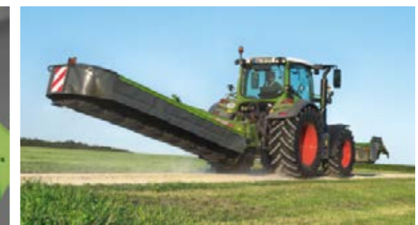
La segadora puede girarse hasta 90° hacia la parte trasera desde la cabina cuando esta se encuentra en la posición de transporte.
