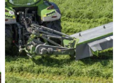
El montaje de resorte garantiza una baja presión sobre el suelo y protege la cubierta vegetal.
