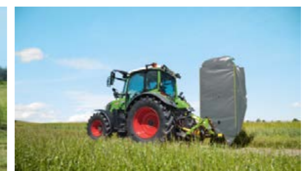
Cambie de la posición de funcionamiento a la posición de transporte compacta desde la cómoda cabina del tractor.
