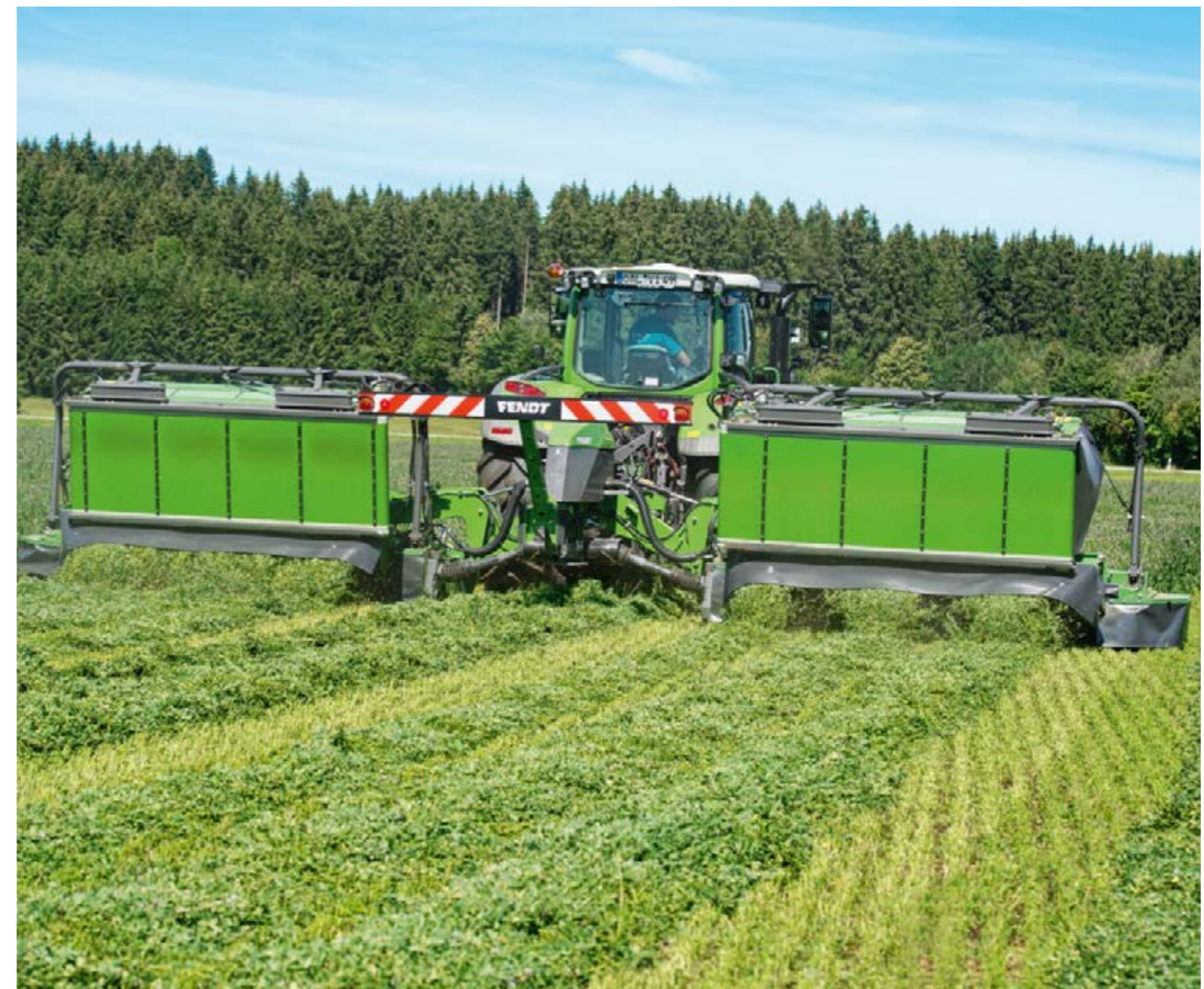
Con tan solo pulsar un botón, las cintas pueden plegarse hacia arriba y el material de cosecha puede descargarse en toda la anchura.
