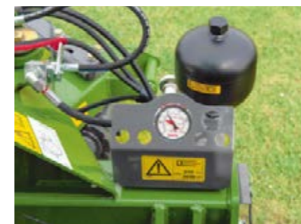
La compensazione idropneumatica TurboLift consente una flottazione ottimale durante il taglio.
