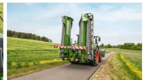
Una volta ripiegata, la falciatrice combinata assume un'altezza inferiore a 4 m e può essere facilmente trasportata grazie al baricentro basso.
