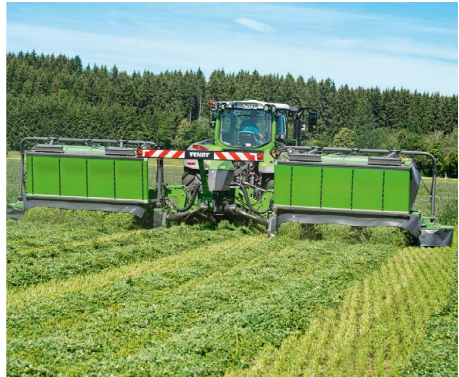
I nastri trasportatori possono essere ripiegati e il raccolto può essere così scaricato lungo tutta la larghezza alla pressione di un pulsante.
