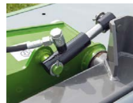
Il cilindro di compensazione stabilizza l'unità di falciatura a fine campo e su strada.
