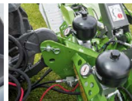
Il manometro di campo fornisce una panoramica della perfetta pressione di contatto del sistema TurboLift e ne consente la regolazione dalla cabina.
