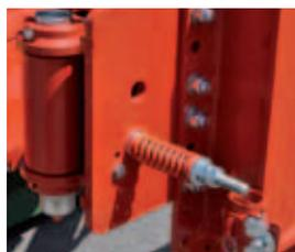
Abnehmbarer Schutztopf zur leichten Gelenkwellenmontage.
