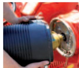
Integrierte Halterung zur bequemen Ablage der Gelenkwelle.
