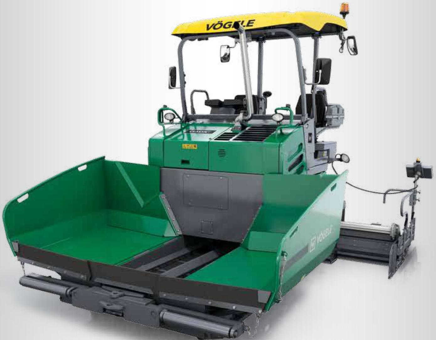
Maximale Einbaubreite 3,90 m
