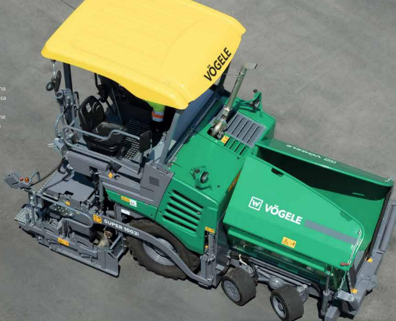
» **La SUPER 1003i** è perfettamente attrezzata per eseguire rapidi trasferimenti in semovenza con velocità fino a 20 km/h. A richiesta la finitrice può essere dotata di un impianto d'illuminazione omologato per la circolazione stradale. Quindi la macchina soddisfa il presupposto di base per circolare sulle strade pubbliche.
