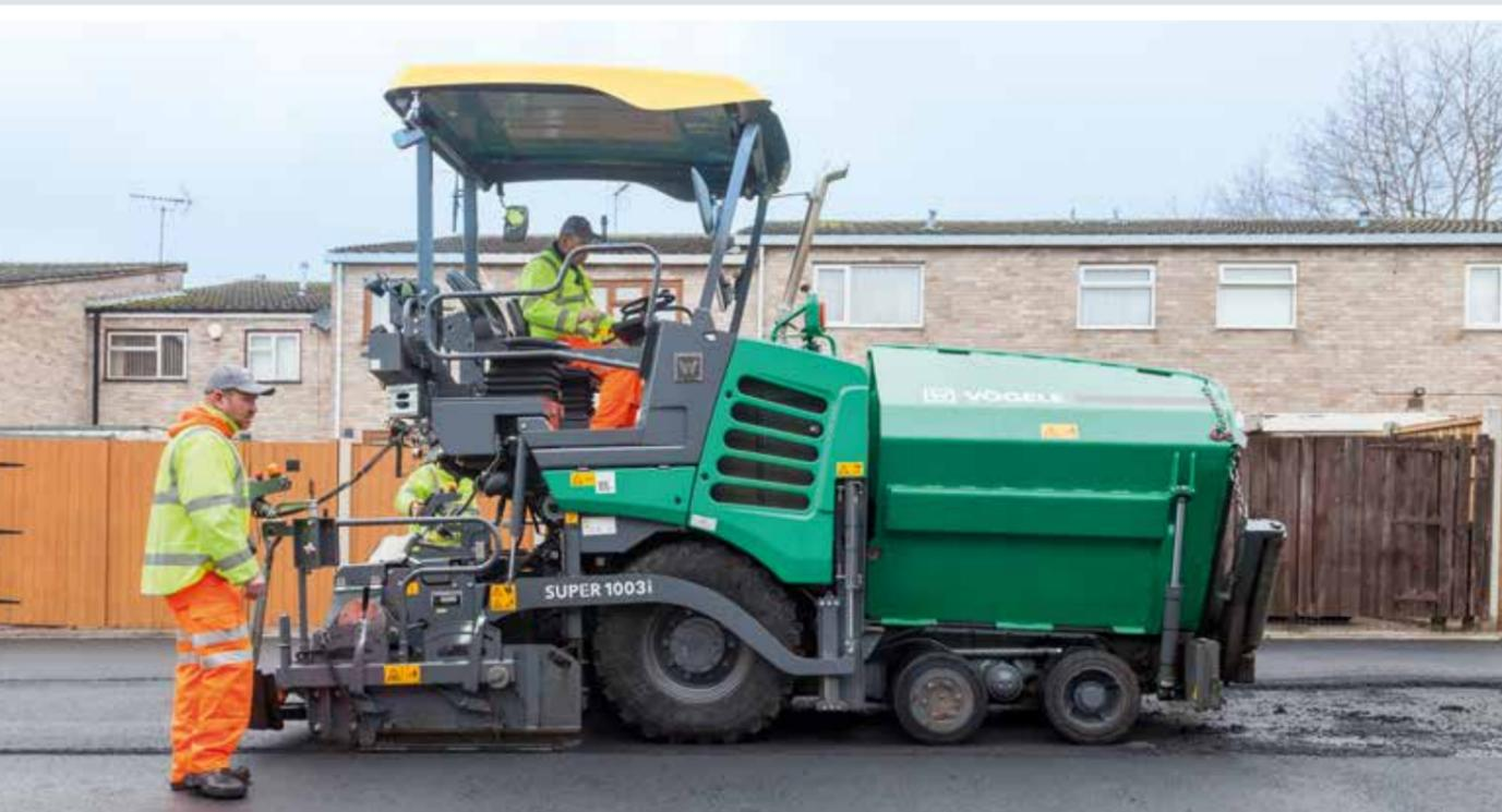
Il propulsore della SUPER 1003i con marmitta catalitica ossidante (DOC) per il post-trattamento dei gas di scarico soddisfa i severi limiti imposti dalle normative antinquinamento Fase 4 europea ed EPA Tier 4f statunitense.
