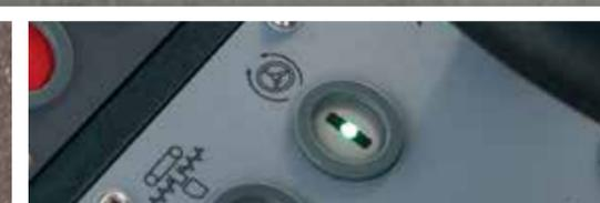
**Estrema maneggevolezza** grazie al "Pivot Steer": con il freno sterzante "Pivot Steer" attivato viene frenata idraulicamente la ruota posteriore interna alla curva, riducendo a soli 3,8 m il raggio di sterzata esterno sia durante la stesa che durante le manovre di accostamento. La funzione è attivabile nelle modalità operative "Stesa" e "Accostamento" e migliora decisamente la maneggevolezza della macchina nei cantieri stretti.
