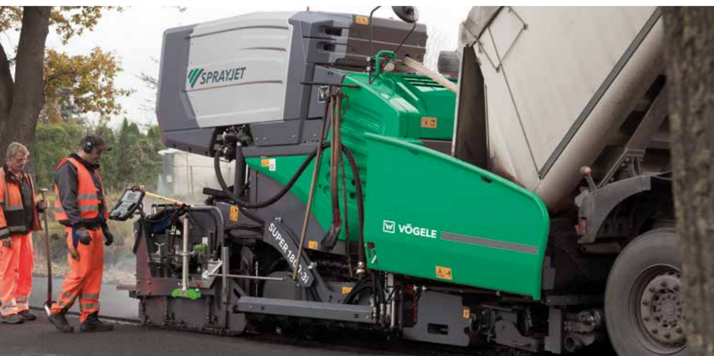
La estación de accionamiento de la SUPER 1800-3i SprayJet con catalizador de oxidación de diésel (DOC), con filtro de partículas para motores diésel (DPF) y reducción catalítica selectiva (SCR) para el tratamiento posterior de gases de escape cumple las estrictas estándares de la normativa europea sobre emisiones Fase V y de la norma estadounidense EPA Tier 4f.
