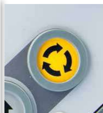
Une simple pression sur la touche d'exécution permet de lancer la fonction de repositionnement « AutoSet Plus ».
