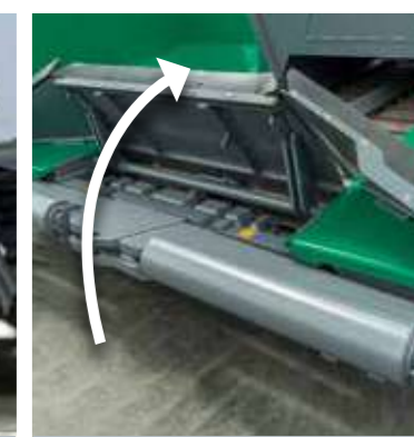
Relever le clapet de recentrage de la trémie.
