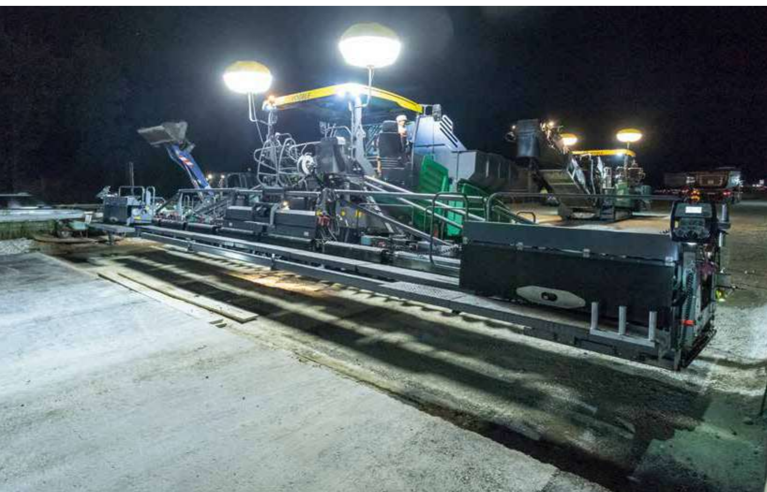
Une simple pression sur la touche d'exécution permet de lancer la fonction de repositionnement « AutoSet Plus ».
