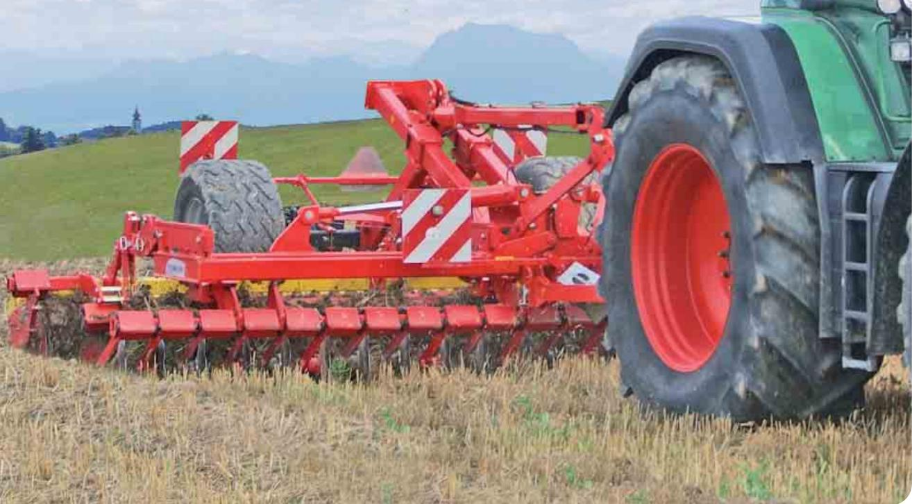
Závěs kat. 2 nebo 3 pro aggregaci do spodních rámů traktoru. Dlouhá oj s otočným čepem umožňuje při otáčení výkyv až 90°.
