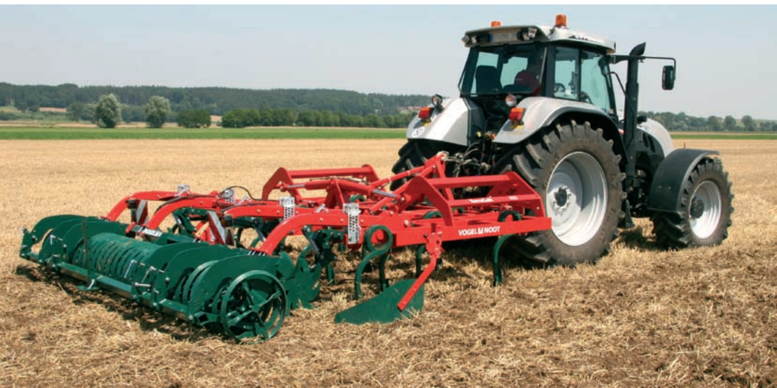
TerraCult 400, ripieghevole con molle elicoidali e rullo Terrapak.
