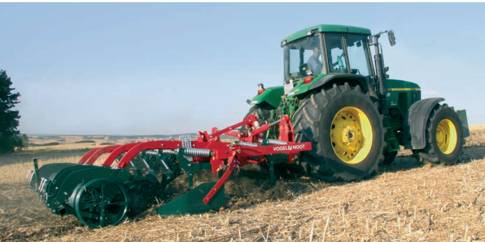
TerraFlex 400 richiudibile con sistema non stop con molle addizionali e rullo Terrapak
