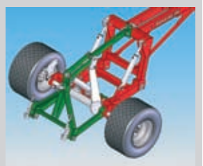
Opzionale: attacco idraulico per TerraLift S
