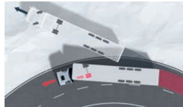
ESP-Ausgleichsbremung beim Untersteuern des Zugfahrzeugs.
