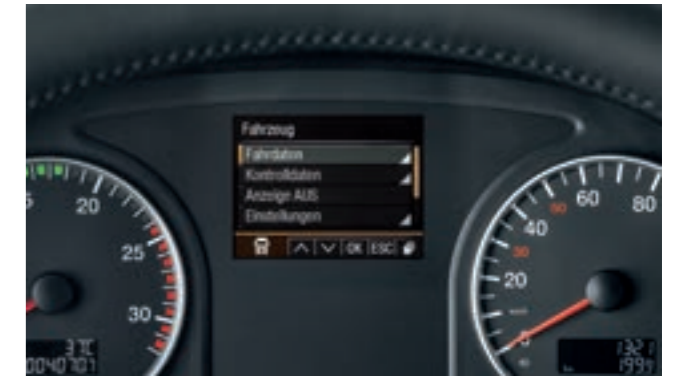
Verbessertes Farbdisplay im Kombiinstrument.
