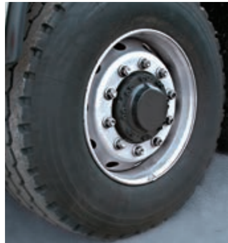
Vorderachse mit hydrostatischen Radnabenmotoren.
