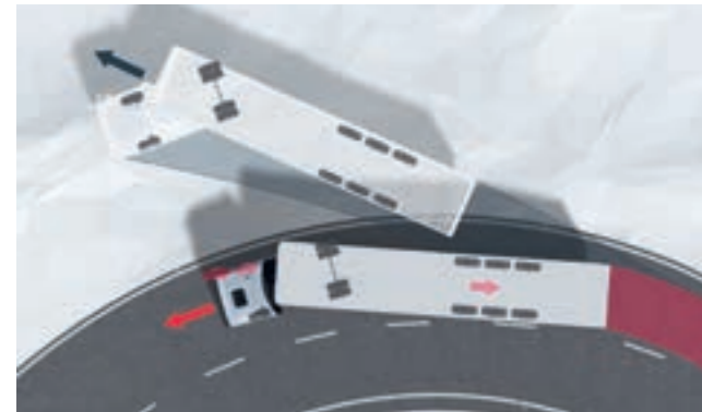
ESP-Ausgleichsbremung beim Übersteuern des Zugfahrzeugs.
