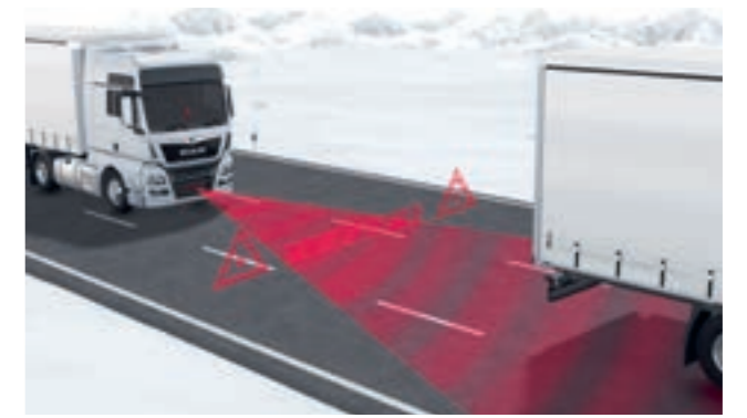
EBA-Funktionsprinzip: Verkehrsraumüberwachung durch Nutzung zweier unabhängiger Sensorsysteme (Radar und Video).
