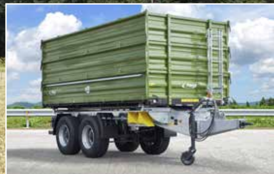
TDK 160 s nástavbou 1800 mm (bočnice 3 x 600 mm)
