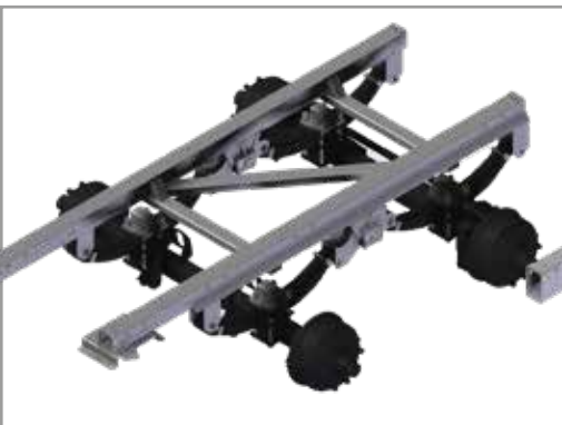
Tandemový agregát Gigant (TMK 200 od délky korby 5,65 mm)
