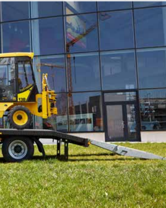
Nájezdové rampy obložené dřevem, dno plošiny z ocelového plechu 3,5 mm lakovaného u TPA 120
