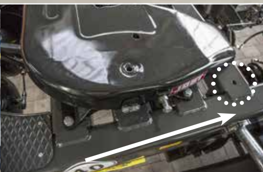
Mechanické nastavení podkovy tahače pro jednonápravový a tandemový přívěs s točnou
