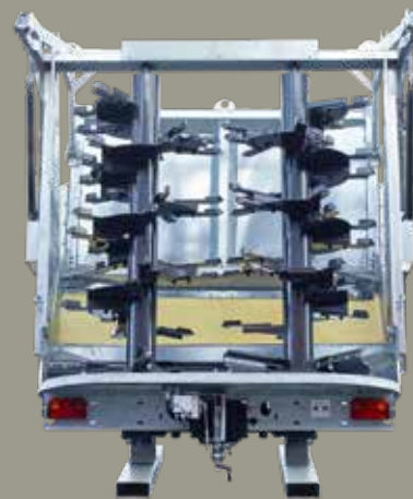
Frézovací válec s rozmetacími lopatkami
