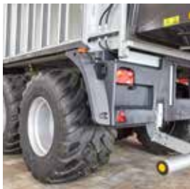
Blatníky, kryty kol a zadní zástěrka vyrobená ze speciálních plastových dílů zajišťujících čistý povrch a nižší riziko poranění člověka o stroj
