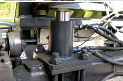
Volitelně: Hydraulická podpora na nápravě
