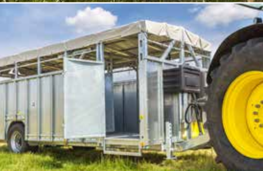
Vstupní dveře vpředu vpravo v sériové výbavě
