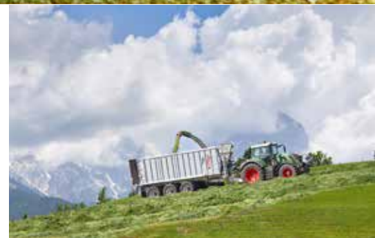
Příznivě umístěné těžiště díky nízké konstrukci
