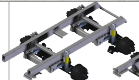
Hydraulické odpružení náprav
