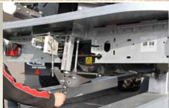
Rychlost dopravy materiálu se reguluje pomocí automatické regulace posuvu
