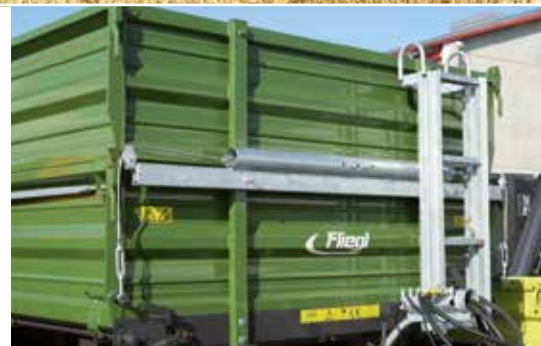
Volitelně: Tažná pružina bočnic v těžkém provedení
