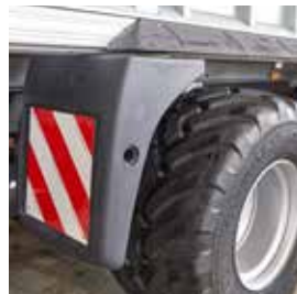
Blatníky, kryty kol a zadní zástěrka vyrobená ze speciálních plastových dílů zajišťujících čistý povrch a nižší riziko poranění člověka o stroj
