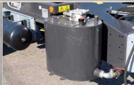
Hydraulika s pohonem kloubovým hřídelem – volitelně
