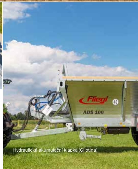
Nejmenší opotřebení díky hydraulickému systému posuvu – žádné drapákové dno.
