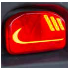
Zadní LED světlo „Dynamic“ s funkcí dynamických směrových světel, vyrobené z materiálu odolného proti nárazu
