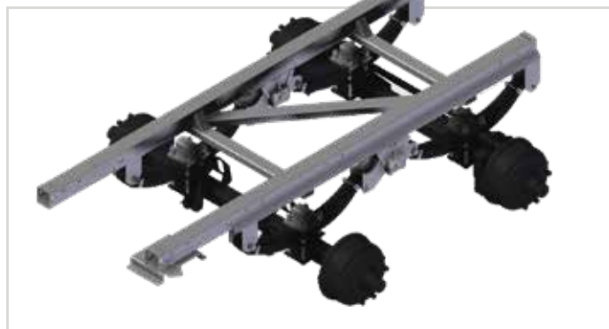
Tandemový agregát Gigant – listové pružiny
