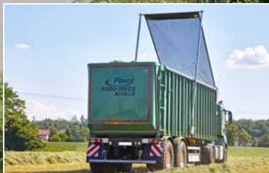
Napínání pomocí pružinových upínačů
