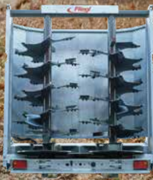
Frézovací válec s vyhazovacími lopatkami
