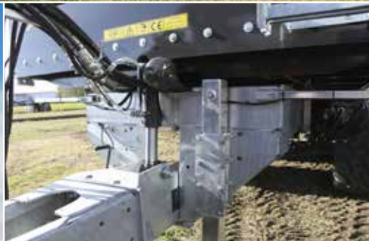
Hydraulické odpružení oje
