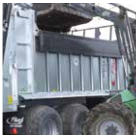
Mechanické sklápění bočnic
