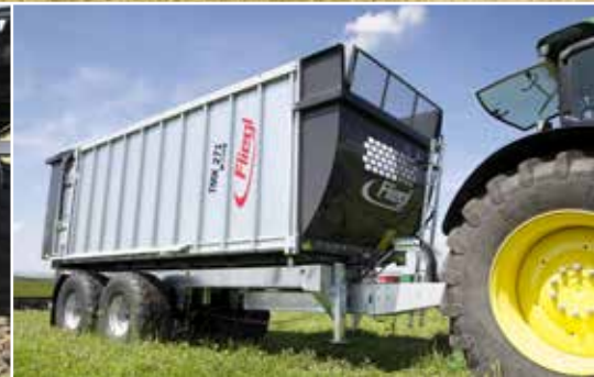
TMK BULL 276 se zaoblenou čelní stěnou
