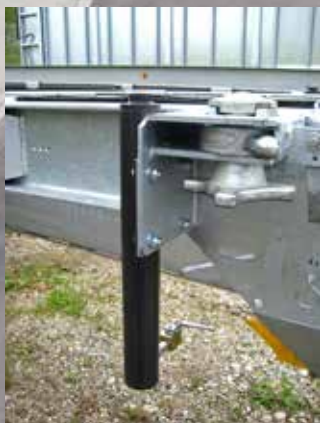
Válce pro hydraulické zvedací zařízení
