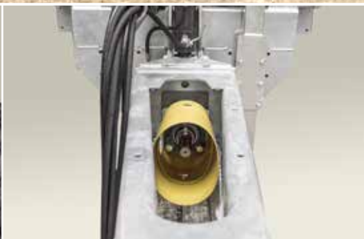
Rozmetadlo se pohání mechanicky pomocí průchodky vývodového hřídele
