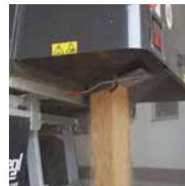
Velkoobjemová zadní stěna s vyprazdňovacím okénkem
