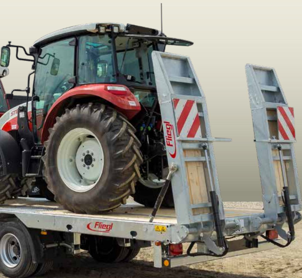
TPA 370 Čelní stěna 800 mm v sériové výbavě Nájezdová rampa sklopná
