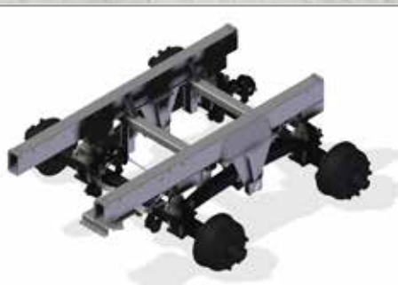
Tandemový agregát Titan pro s nízkým těžištěm aplikace
