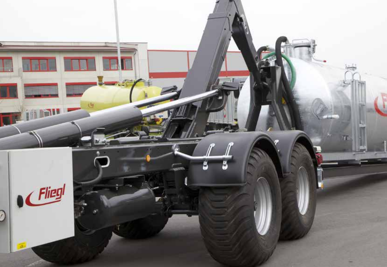
Kovaný, snadno vyměnitelný nosný hák
