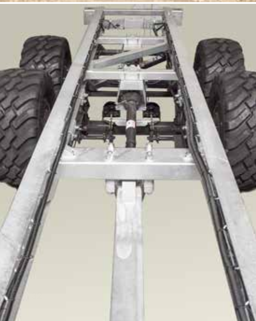
Rozmetadlo se pohání mechanicky pomocí průchodky vývodového hřídele
