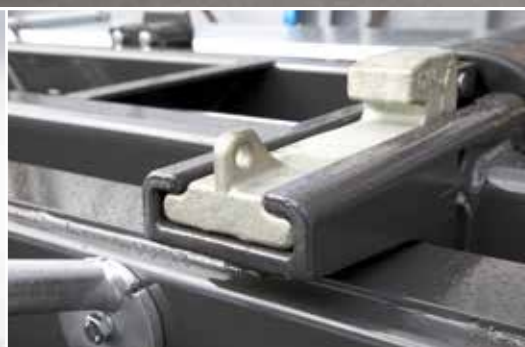
Systém zajištění se zásuvnými zámky pro zajištění zevnitř i zvenku
