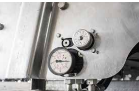
Mechanický potenciometr s nastavitelnou rychlostí posuvu na rozmetadle
