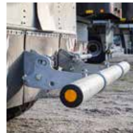
Volitelně: Ochrana proti podjetí mechanicky sklopná
