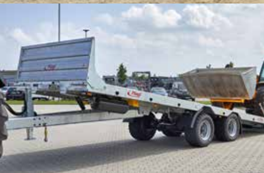
Hydraulicky sklopné oje
