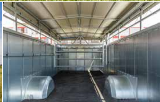
Nastavitelná dělicí mříž a podlaha z rýhovaného plechu s odtokovým otvorem
