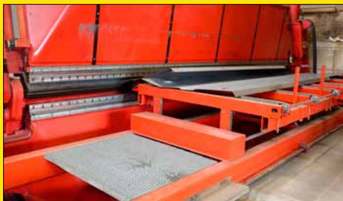
Plièse à commande numérique d'une force de pression de 600 tonnes
