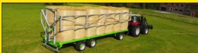
En option sur les modèles 8000D13, 10000T15 et 10000T20, des barrières latérales hydrauliques (2 SE) apportent sécurité et rapidité d'utilisation
