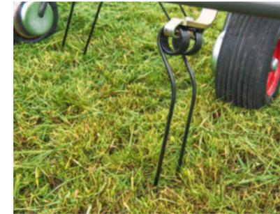
Los soportes de las púas tienen una superficie de contacto resistente a la torsión y extraordinariamente ancha en la placa de rotor.
