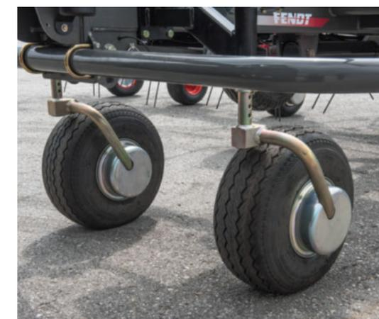
□ Le ruote tastatrici girevoli come optional assicurano l'adattamento al terreno e una raccolta pulita con buona protezione del manto erboso. (Fendt Twister 901 T)
