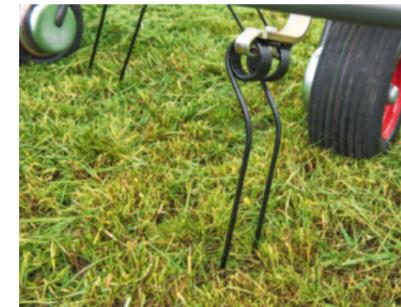
I portadenti presentano una superficie di contatto sul disco del girante particolarmente ampia e resistente alla torsione.
