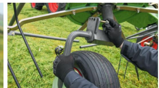
L'angolo di spandimento può essere settato in modo semplice e veloce fra 15, 18 e 21°, impostando la posizione desiderata in un foro della piastra posizionata sopra le ruote.
