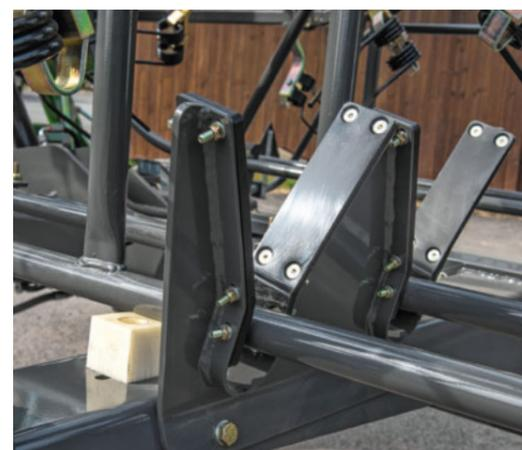
■ Il telaio del Twister si adatta perfettamente ai supporti speciali con forma a V durante il trasporto. (Solo su Fendt Twister in versione con telaio di trasporto.)
