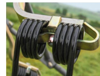
Tutti i denti "Super C" sono dotati di serie di un dispositivo di protezione contro la perdita, per proteggere le operazioni successive e gli animali.
