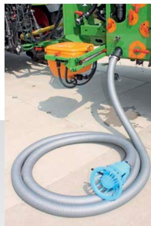
Riempimento mediante tubo di aspirazione
