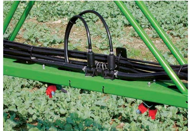
Poiché il liquido di irrorazione mantiene una pressione costante nell'intero sistema di tubazioni, fino agli ugelli, l'inizio irrorazione, risulta agevole.
