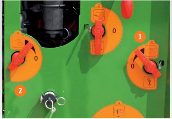
Nei polverizzatori AMAZONE, il flusso di lavaggio proveniente dal filtro a pressione autopulente viene utilizzato per l'agitazione (attivazione tramite pos. 1). Per potenze di agitazione elevate e bassi regimi all'albero della p.d.f., si consiglia l'equipaggiamento con la pompa dell'UG Super (attivazione tramite pos. 2).
