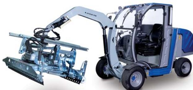
Equipée d'une cabine confort complète et indépendante, d'un siège standard avec amortissement mécanique, d'un écran 2,4" et flèche standard
