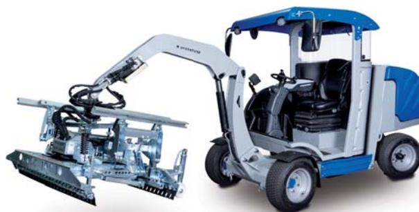
Modèle d'entrée de gamme avec cabine d'opérateur partiellement fermée, siège standard réglable avec suspension mécanique, écran de 2,4" et flèche standard.
