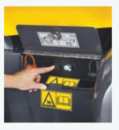
• Haubenschalter, Batteriehauptschalter und externe Batterieklemmen sind am Heck angeordnet
