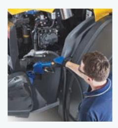
• Aus Sicherheitsgründen der 246-l-Kraftstofftank und der 37-l-AdBlue-Tank nur bei aufgestellter Motorhaube zugänglich
