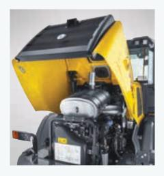
• Die einteilige Motorhaube ist bei den Modellen W130 D und W170 D elektrisch aufstellbar
