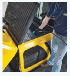
• Der leichte Zugang zu den einzelnen Kühlern ermöglicht eine einfache Reinigung
