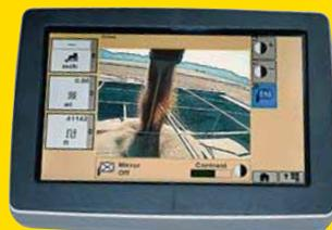
Интегрированная функция отображения видео на дисплее GreenStar 3 обеспечивает идеальный обзор задней части комбайна, внутренней части зернового бункера или выгрузного шнека, предоставляя отличные, индивидуально настраиваемые ракурсы видеосъемки, при наличии камеры.
