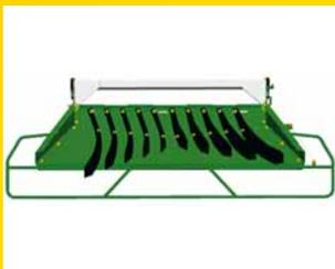
Для равномерного разбрасывания при поперечном ветре и на склонах измельчитель оборудован регулируемыми щитками с электроприводом. Это позволяет оператору разбрасывать материал влево или вправо от комбайна.
