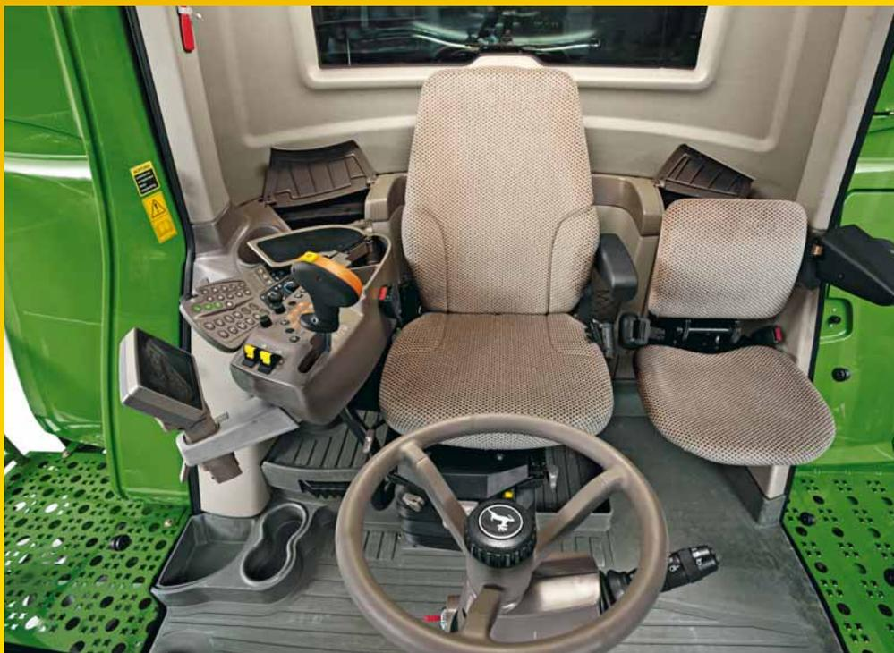
Комфортное сиденье на пневматической подвеске обеспечивает исключительный комфорт в течение всего дня. Все органы управления логичны, эргономичны и легко понятны. Мягкие переключатели позволяют с большей, чем когда-либо прежде, легкостью выполнять точную настройку комбайна.
