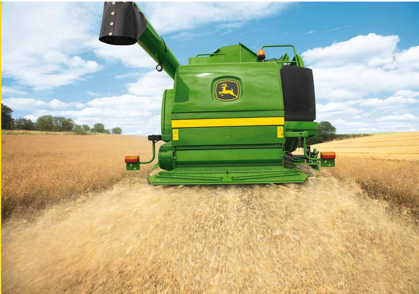
Система обработки пожнивных остатков позволяет разбрасывать полову в стороны и обладает бесступенчатой регулировкой ширины разбрасывания, что позволяет распространять измельченный материал на всю ширину самых больших жаток.
