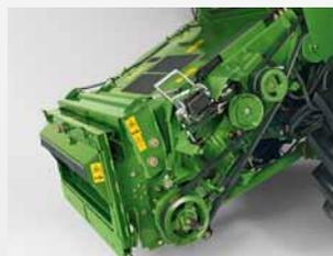
**Усиленный привод наклонной камеры**
