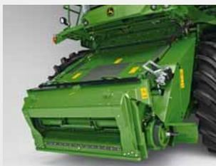
**Наклонная камера большой емкости для комбайнов серии W**
