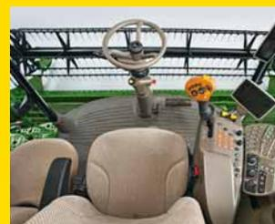
**Обзор, недостижимый прежде** – обеспечивает оператору максимальный комфорт и полный визуальный охват для контроля ведения уборки. Исключительный обзор достигается благодаря новой форме и конструкции угловых стоек кабины, а также увеличенной площади остекления.
