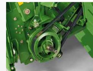
**Механизм реверса наклонной камеры**
