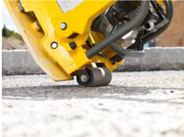
Los robustos rodillos de transporte integrados ofrecen un alto grado de movilidad.
