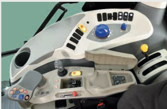
L'intérieur de la cabine dans la version VT-Drive : les commandes du tracteur sont regroupées sur l'accoudoir multifonction à droite du conducteur.
