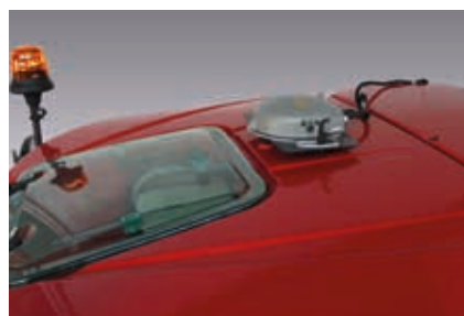
L'antenne satellitaire placée sur le toit de la cabine reçoit le signal GPS.
