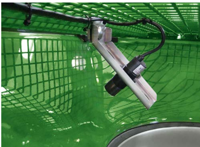
✓ Sensor de tolva vacía en una ZA-TS
