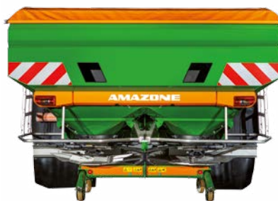
Sobretolva L 4200 (ancho de llenado 2,71 m) con escalerillas plegables
