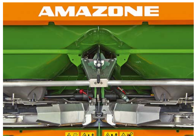
Panel de dispersión en bancales en posición de trabajo por ambos lados con extremos telescópicos
