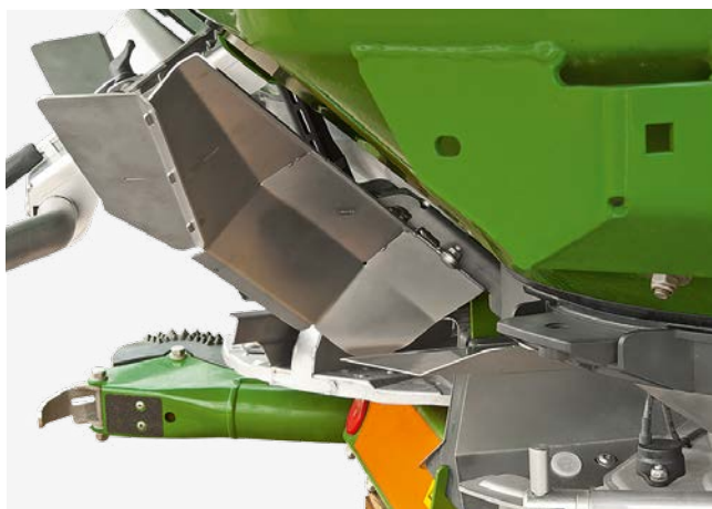
Dispositif d'épandage depuis la bordure relevé
