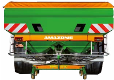
Réhausse L 4200 (largeur de remplissage 2,71 m) avec échelles repliables
