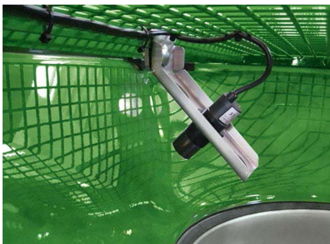
Sensore di livello del fertilizzante nello ZA-TS
