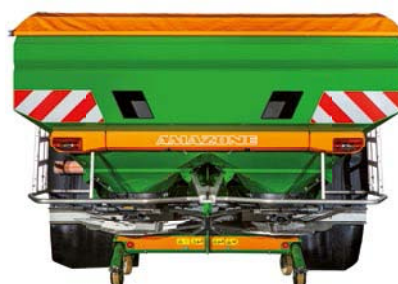
Sovrasponda L 4200 (larghezza di riempimento 2,71 m) con scalette pieghevoli
