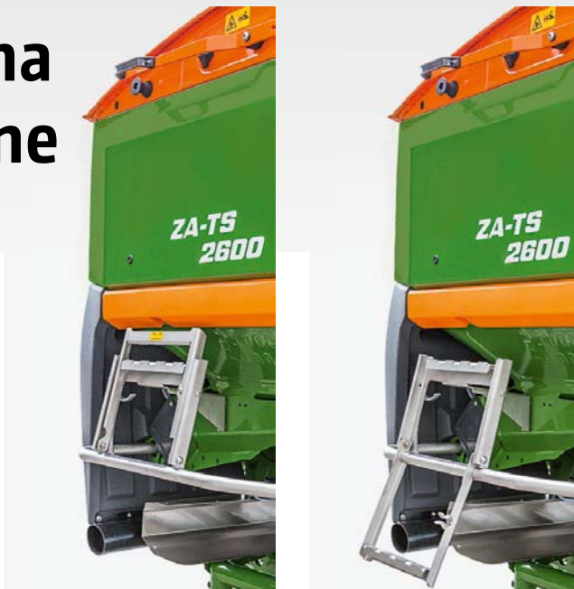
Scala ripiegabile nello ZA-TS con sovrasponda S 2600
