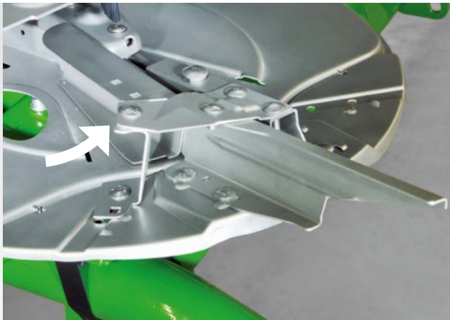
AutoTS – Instelling voor normaal strooien
