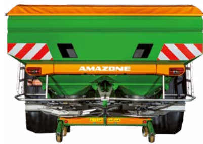
Opzetrand L 4200 (vulbreedte 2,71 m) met opklapbare ladders
