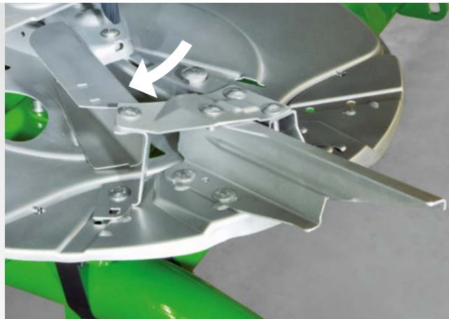
AutoTS – Instelling van de aanvoerschoep voor kantstrooien
