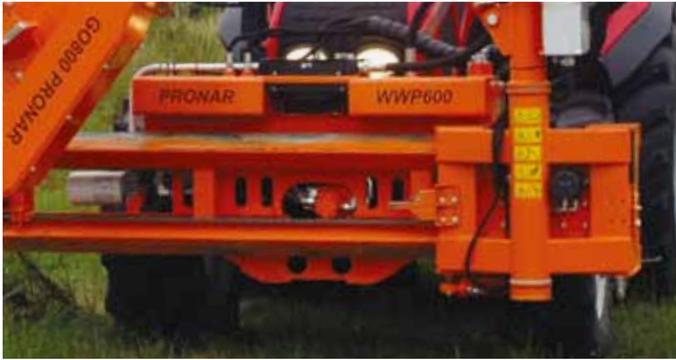
Ausleger WWP600- hydraulischer Schub des Arbeitsarms über die Führung.
