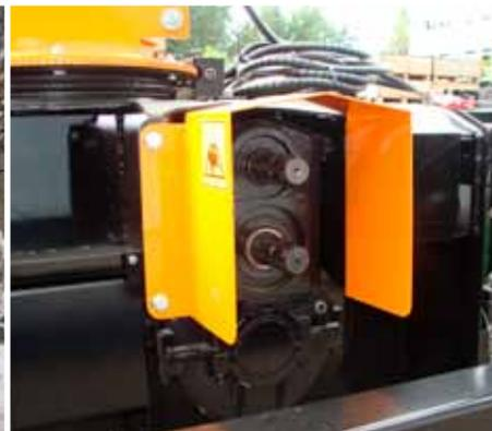
Hydraulische Auswurfrohrdrehung und Regulierung des Auswurfsabstands.
