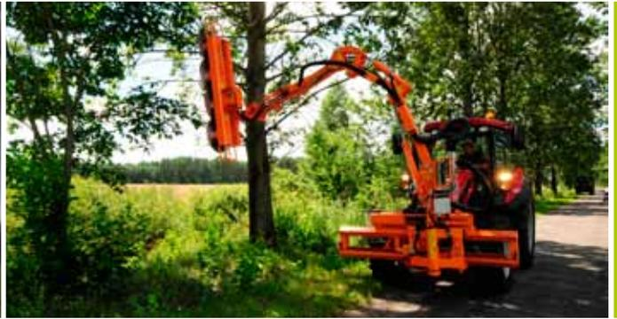
Ausleger WWP600 mit Säge zum Schneiden von Ästen GP200.
