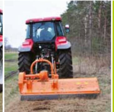
Der hydraulische Schub erlaubt das Mähen außerhalb des Schlepperumrisses.
