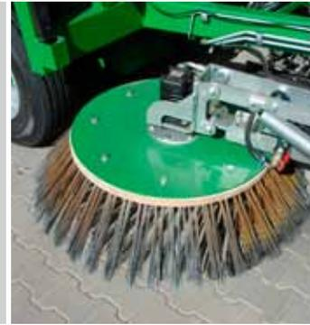
Hydraulische Lageverstellung für Tellerbürsten.
