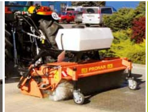
Wassersprühleinrichtung zur Reduzierung der Staubemission
