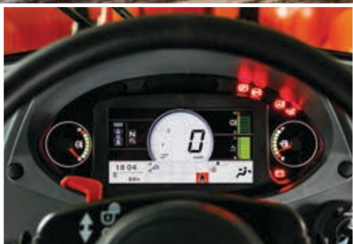
Il nuovo monitor LCD mostra lo stato e le impostazioni della macchina.
