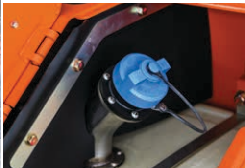
L'urea viene iniettata nel gas di scarico per ridurre le emissioni.
