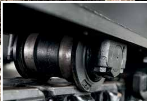
Versterkt lagermateriaal verbetert de slijtweerstand.
