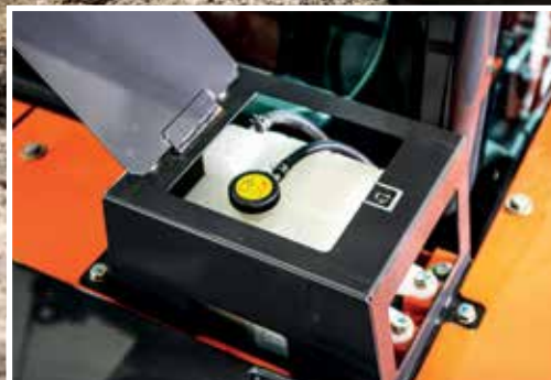
De expansietank voorkomt oververhitting van motoronderdelen.
