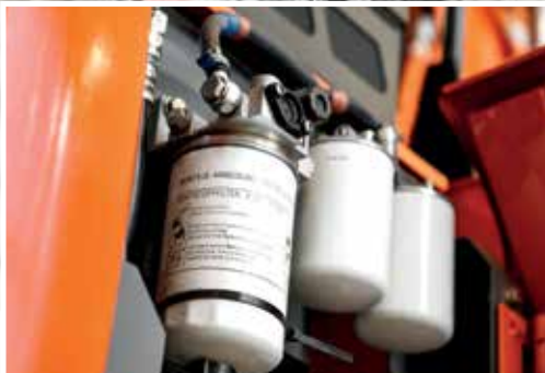
El filtro de combustible principal es más fácil de sustituir.
