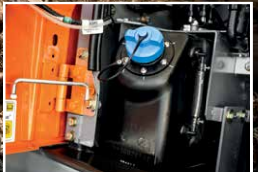
Er wordt AdBlue® in het uitlaatgas geïnjecteerd zodat uitstoot afneemt.
