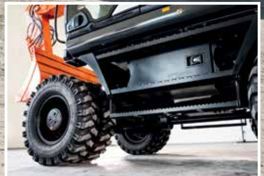
Hoge bodemvrijheid vermindert beschadiging door obstakels.
