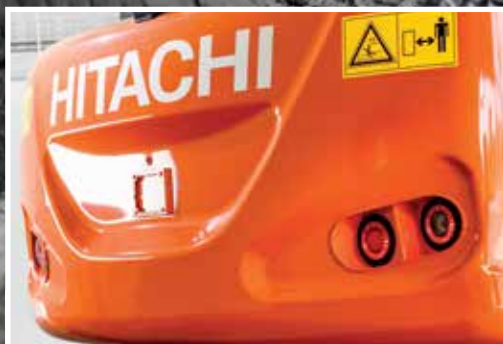
Światła tylne w technologii LED są łatwe w obsłudze technicznej.
