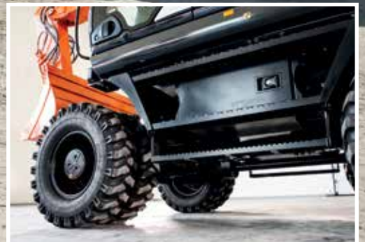
Duży prześwit zmniejsza możliwość uszkodzenia powstającego na skutek uderzeń w przeszkody.
