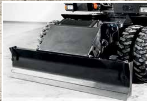
Duża osłona siłownika lemiesza zapewnia lepszą ochronę.
