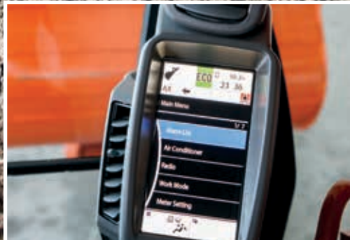
El monitor LCD muestra el estado y la configuración de la máquina.
