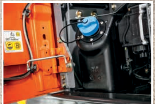
La urea se inyecta en los gases de escape para reducir las emisiones.
