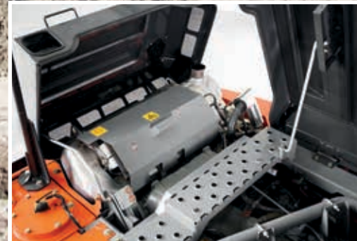
El sistema SCR reduce las emisiones y los niveles de ruido.
