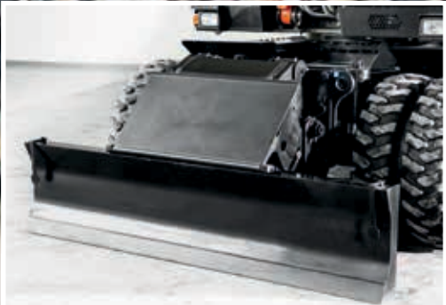
Grote cilinderkap biedt betere bescherming.
