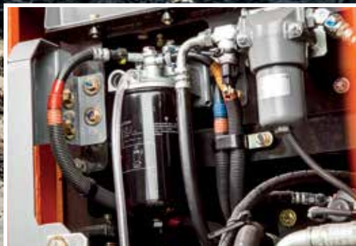
El filtro de combustible principal es más fácil de sustituir.
