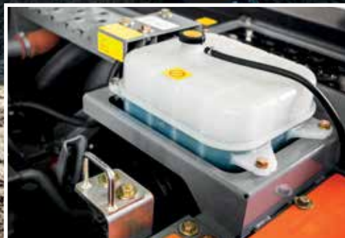
El depósito de expansión impide que los componentes del motor se calienten.
