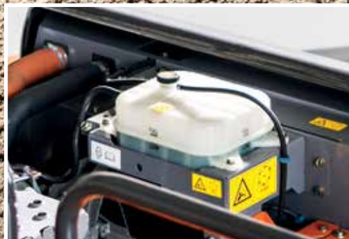
Expanzní nádržka zabraňuje přehřívání součástí motoru.
