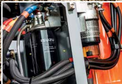
Hlavní palivový filtr lze snáze vyměnit.
