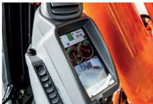
Stav a nastavení stroje se zobrazuje na LCD monitoru.
