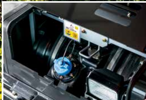
Vstřikování močoviny do výfukových plynů snižuje emise.
