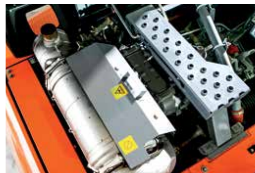
System SCR snižuje emise a hladinu hluku.
