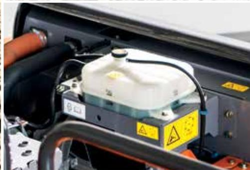
Der Ausgleichsbehälter im Kühlkreislauf verhindert, dass Motorteile überhitzen.
