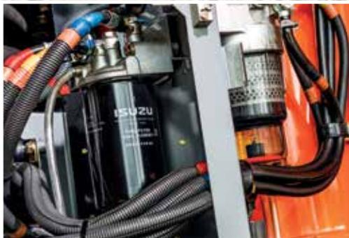
Der Kraftstoffhauptfilter lässt sich einfacher auswechseln.
